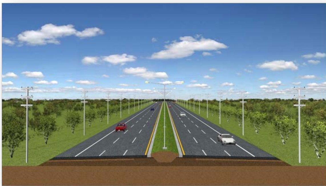
รูปที่ 2.1.1-3 รูปตัดและรูปแบบถนนขนาด 6 ช่องจราจร (ไป-กลับ) ช่วงจาก กม.34+639 ถึง กม.42+325 และช่วงจาก กม.43+435 ถึง กม.47+765
